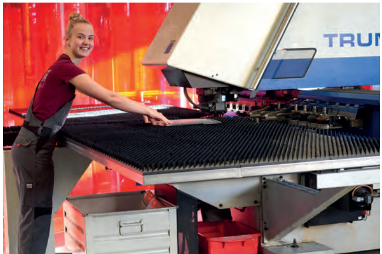
An der Trumpf-Maschine werden Bleche bearbeitet und z.B. die Auskühlgitter gestanzt.
